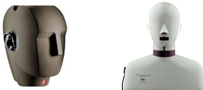
Figura 47 A sinistra una dummy head, a destra un manichino di simile struttura ma che comprende l'ingombro spaziale anche delle spalle. [36]
